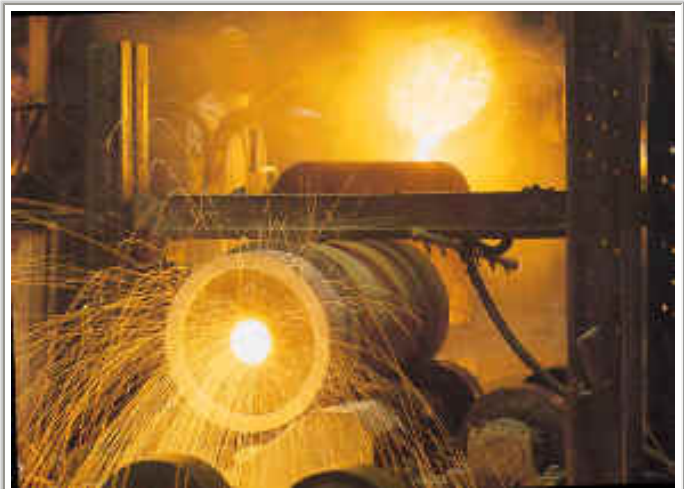
Metal Pour into a Horizontal Centrifugal Mold
